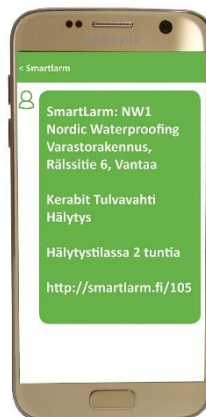
Kuva 2. Ulkoyksikön sisällä oleva SL-100 lähetin on kytkennän jälkeen matkapuhelinverkon kautta yhteydessä SmartLarm.fi -palvelimeen. Tulvatilanteessa hälytys välittyy tekstiviestinä haluttuihin matkapuhelinnumeroihin ja / tai sähköpostiosoitteisiin.
