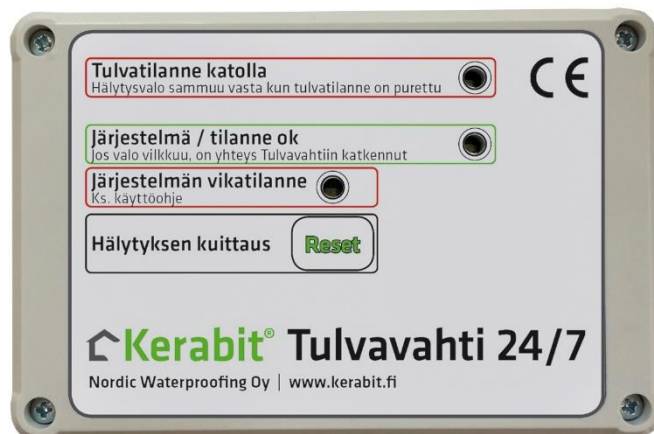
Kuva 2. Paikallishälytin eli sisätiloihin asennettava hälytyksen vastaanotin, joka kytketään pistorasiaan pakkauksen mukana toimitettavalla verkkojohdolla. Vastaanotin on langattomassa yhteydessä ulkoyksikön kanssa ja ilmoittaa tulvatilanteesta äänimerkillä ja hälytysvalolla.
